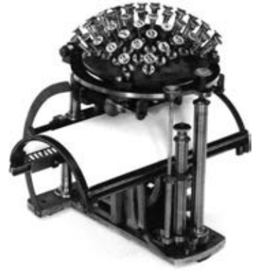
Hans Rasmus Johann Malling-Hansen. Печатная машинка с пятьюдесятью двумя кнопками. Модель 1878 года
